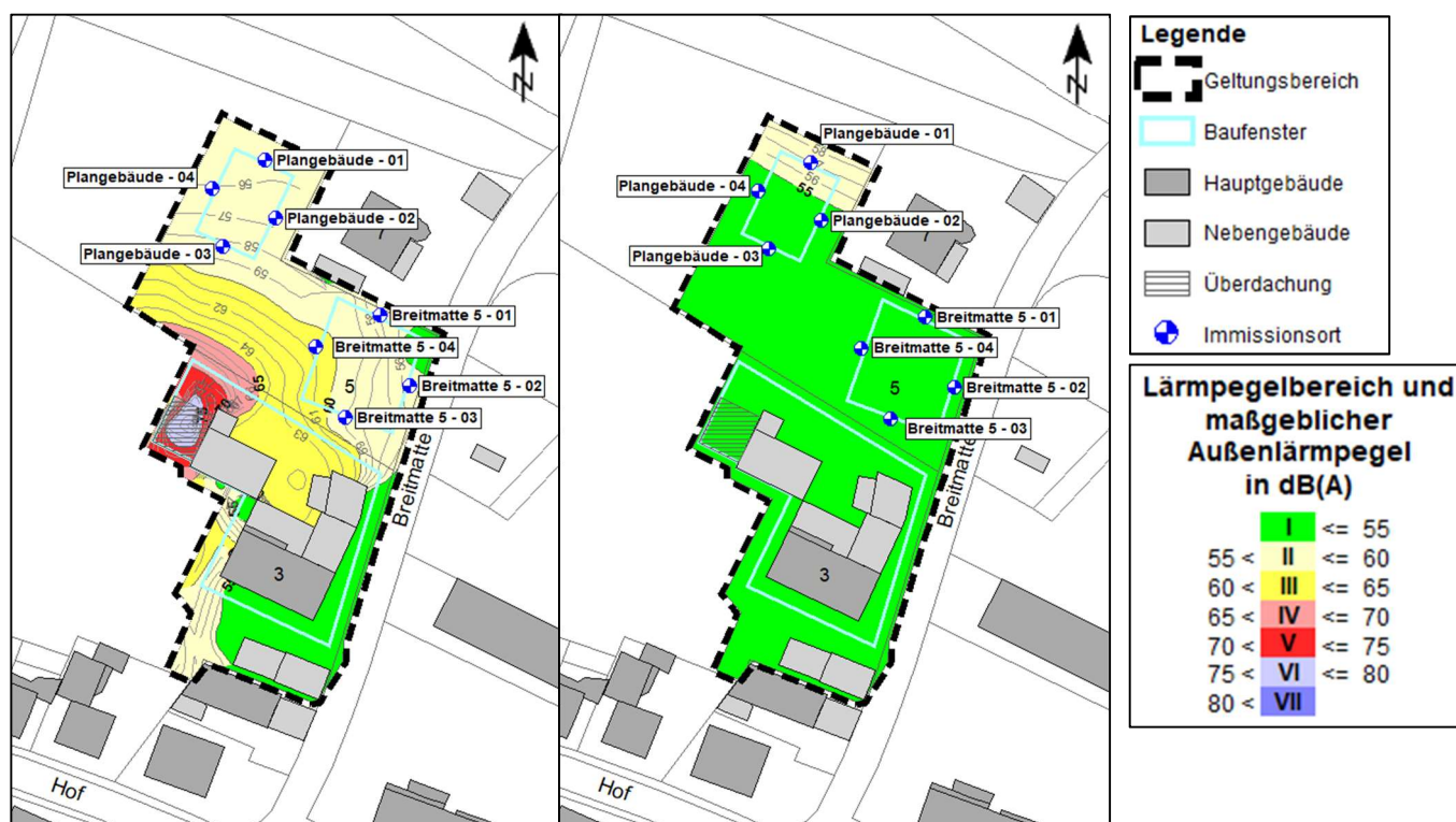
Abbildung 6 – Darstellung der Lärmpegelbereiche gemäß DIN 4109-1 (2018) im tags (links) und nachts (rechts)
